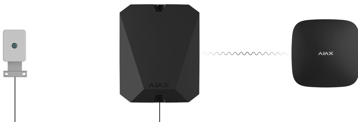
MultiTransmitter se puede utilizar para conectar los botones de pánico y de ayuda urgente, detectores de movimiento para interior y exterior, así como detectores que detectan aperturas, vibraciones, roturas, incendio, gas, fugas, etc.
