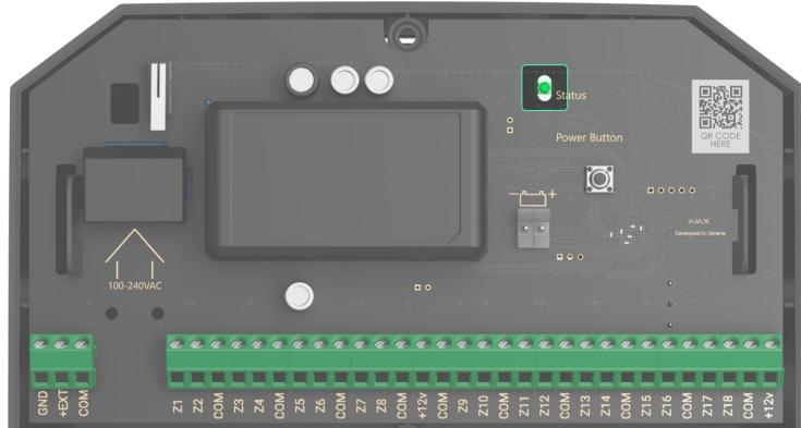
El indicador LED MultiTransmitter puede encenderse en blanco, rojo o verde, según el estado del dispositivo. Tenga en cuenta que el indicador LED no es visible cuando el tamper está cerrado, pero puede verificar el estado del dispositivo en la app Ajax.
