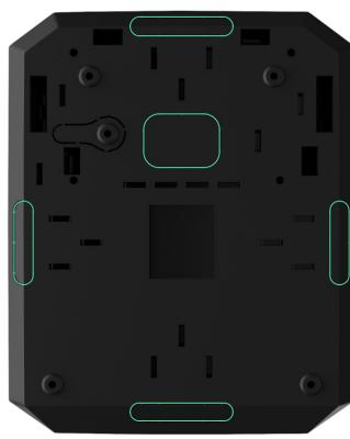
**2.** Sujete la carcasa sobre la superficie vertical en el lugar de instalación seleccionado con los tornillos empaquetados utilizando todos los puntos de fijación. Uno de ellos está ubicado en la pieza perforada sobre el interruptor antisabotaje: es necesario para la activación del interruptor antisabotaje ante cualquier intento de arrancar la carcasa del MultiTransmitter de la superficie.
