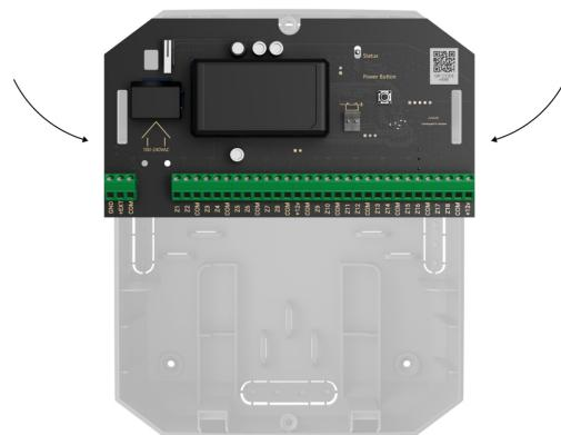
**4.** Instale una batería de reserva de 12 V= en las rejillas de fijación especiales en la carcasa. Tenga en cuenta que las unidades de alimentación de
